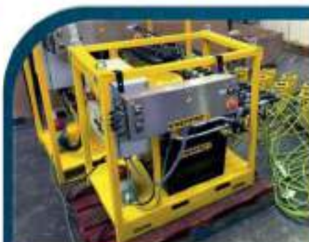
Levage synchro de 4 ou 8 sorties
